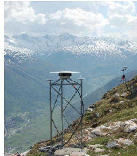
**HEUTE** als GNSS-Permanentnetz (AGNES) mit Verdichtungspunkten (mit mm-Genauigkeit)
